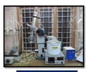
ROTARAY VACUUMFLASH EVAPORATOR
