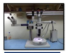
TRINOCULAR STEREOSCOPIC ZOOM MICROSCOPE
