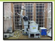
ROTARAY VACUUMFLASH EVAPORATOR
