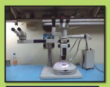
TRINOCULAR STEREOSCOPIC ZOOM MICROSCOPE
